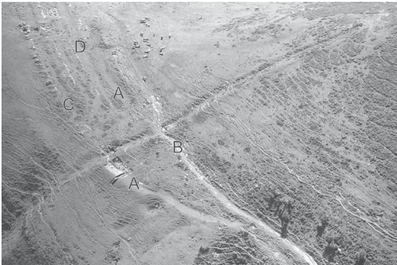
LÁMINA VII. Vía de La Mesa. Sucesión de trazados en el collado de El Muro a 1.650 m de altitud. Se observa la fortificación transversal de los siglos VII-VIII d. C. A) calzada de fines del siglo XVI; B) camino de los siglos XVIII-XIX; C y D) tramos no datados, el primero un variante de A, y el segundo quizás el eje más antiguo.
